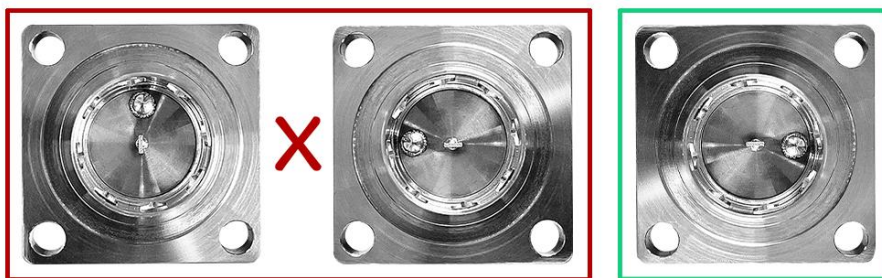
Figura 3 – Instalação dos sensores com relação ao fluxo de líquido
