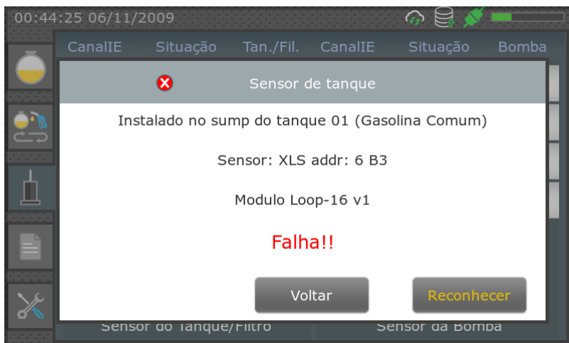
Figura 11 - Alerta de falha no sensor
